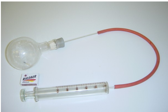
Funktionsweise einer Nebelkammer Glaskolben
