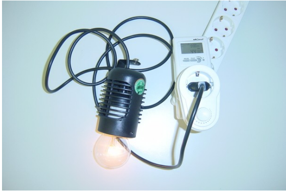
Kennlinie (Arbeit, Leistung,...) einer Glühlampe
